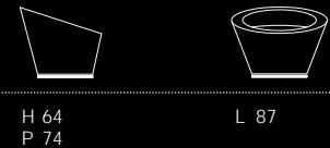
La struttura in legno multistrato di betulla, con imbottitura in espanso a quote differenziate, appoggia su una base in metallo verniciato con meccanismo a sfera. Rivestimento non sfoderabile, disponibile anche in versione ignifuga in Trevira.
